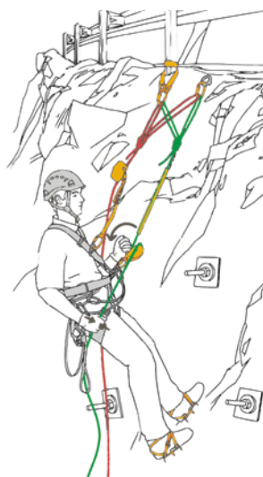
2 Redondance du système grâce à un ancrage indépendant du système de travail et du système de sécurité
