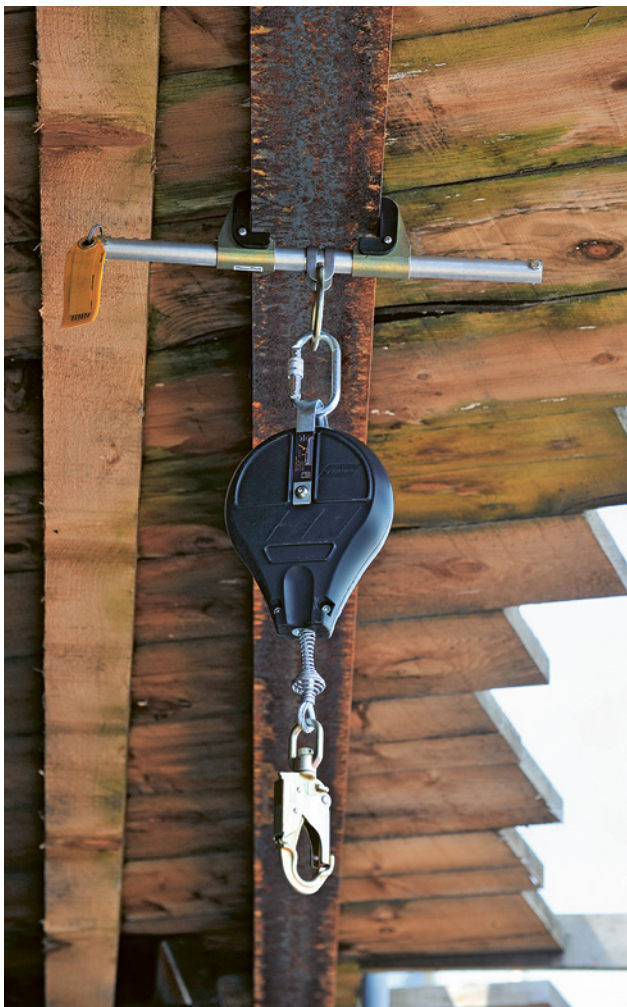
22 An mobilem Anschlagpunkt montiertes Höhensicherungsgerät.
