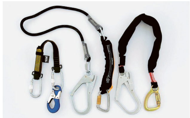
10 Absorbeur d'énergie par déchirure contrôlée monté sur une corde de retenue. Le ruban commence à se déchirer sous une charge d'environ 3 \text{ kN} ( 300 \text{ kg} ).
