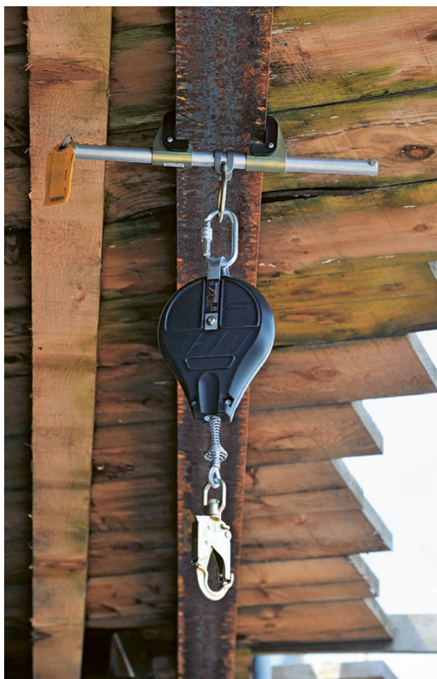
22 Antichute mobile monté sur un point d'ancrage mobile.
