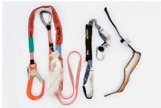
11 Exemples d'absorbeurs d'énergie déchirés. La déchirure amortit le choc d'arrêt en cas de chute.
